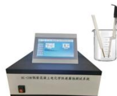
钢筋混凝土电化学快速腐蚀测试系统
